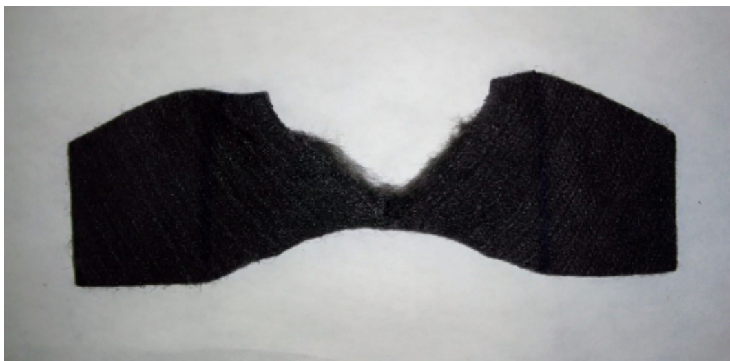
Figura 4 - Amostra depois do ensaio de rasgo trapezoidal
