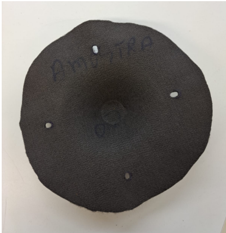
Figura 4 - Amostra depois do ensaio de punção CBR.
