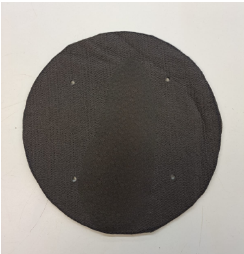
Figura 2 - Amostra virgem do ensaio de punção CBR.
